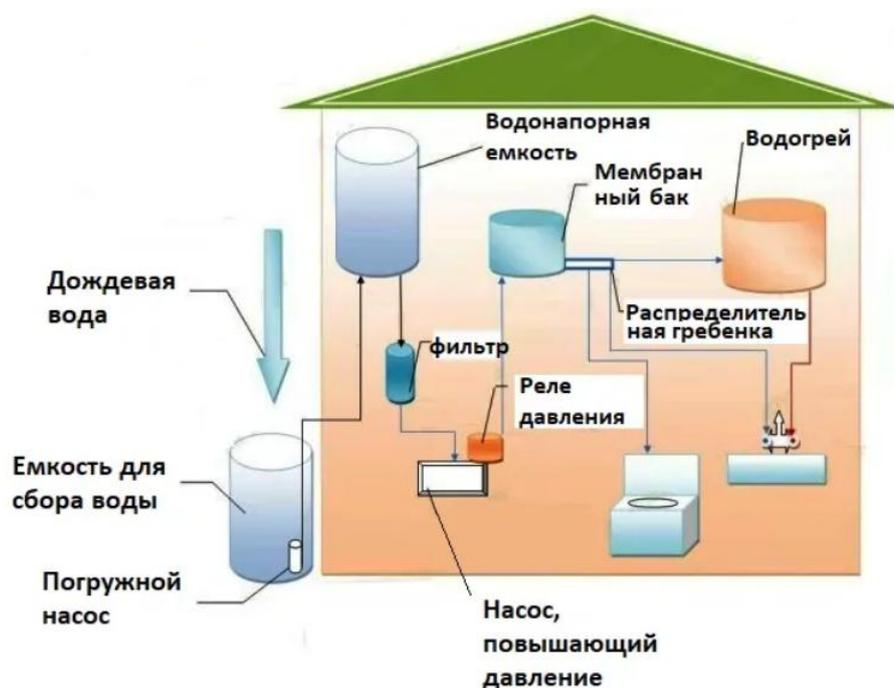
**Рис. 4. Схема водоснабжения дома на дождевой воде**
