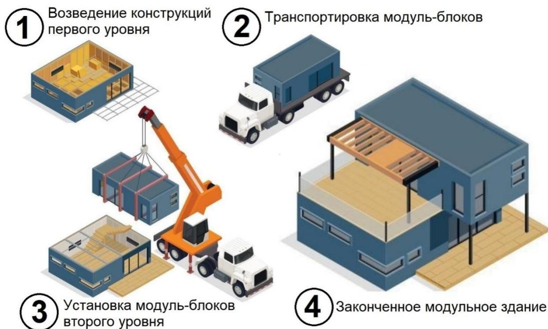
**Рис. 3. Схема возведения модульного здания**
