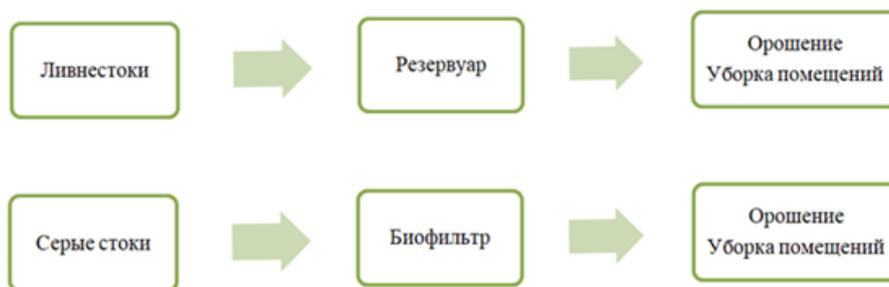
**Рис. 4. Механизм водоиспользования «Ледовой арены»**
