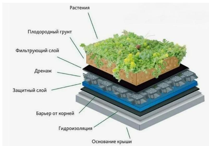
**Рис. 5. Пирог «зелёной» кровли**
